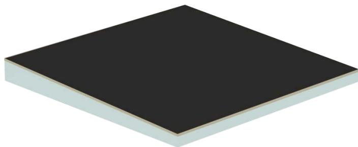
Les panneaux d'isolants rigides sont fabriqués sur mesure par Millenium selon les dimensions et la pente spécifiées. Ils sont composés de polystyrène expansé [PSE] type 1, 2 ou 3, laminés en usine à un panneau de fibre de bois 13 mm afin de répondre aux différentes exigences des projets.
